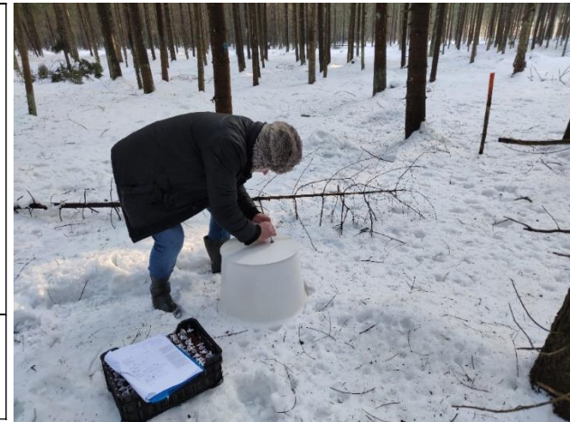
4 pav. CO 2 emisijų nustatymas taikant dinaminį metodą (CO 2 matuoklis EGM-4, PP systems, JAV)
