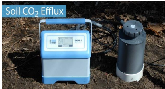
4 pav. CO 2 emisijų nustatymas taikant dinaminį metodą (CO 2 matuoklis EGM-4, PP systems, JAV)
